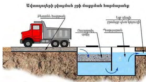
Գծապատկեր 1. Ավտոդողերի լվացումից առաջացած ջրի մաքրման կառուցվածք
